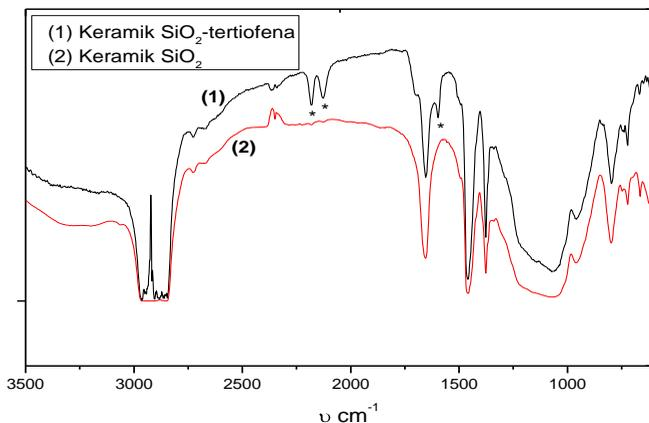
Gambar 8. Spektra FTIR terjadinya CTC pada keramik SiO<sub>2</sub> yang mengandung tertiofena
